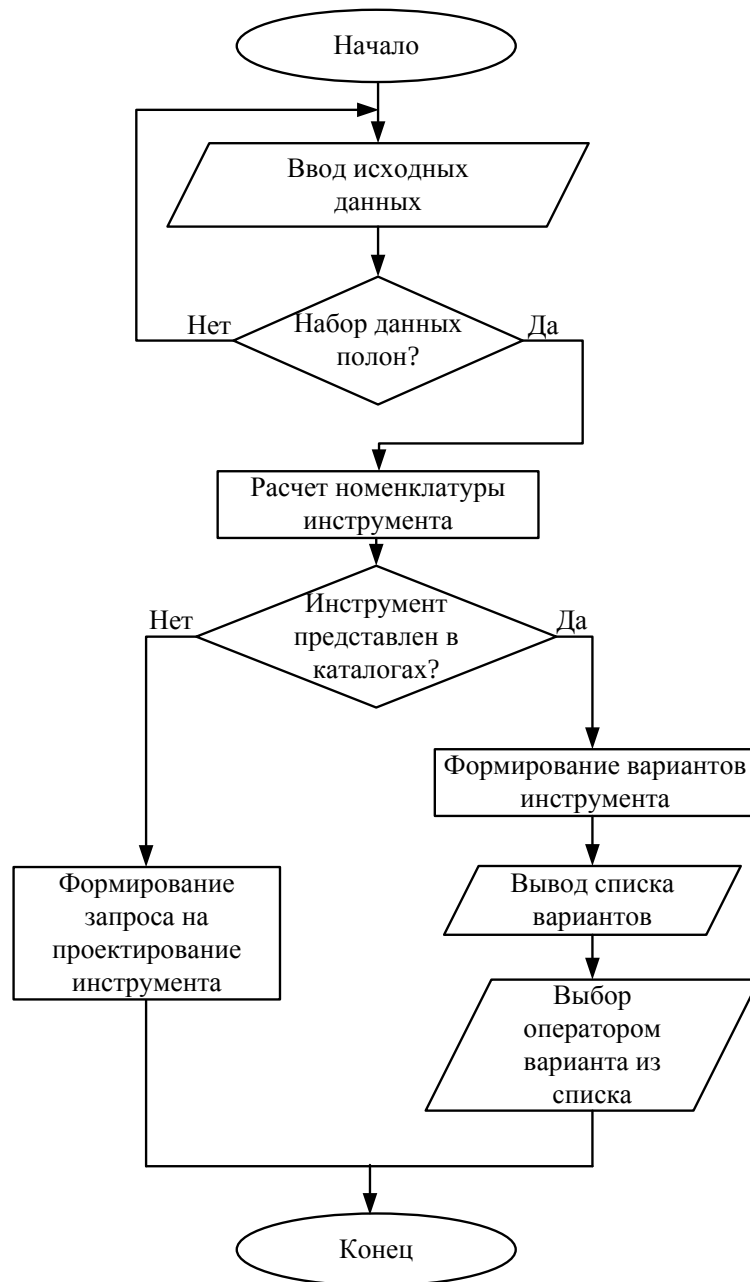
Рис. 1. Алгоритм выбора оптимального инструментального комплекта
