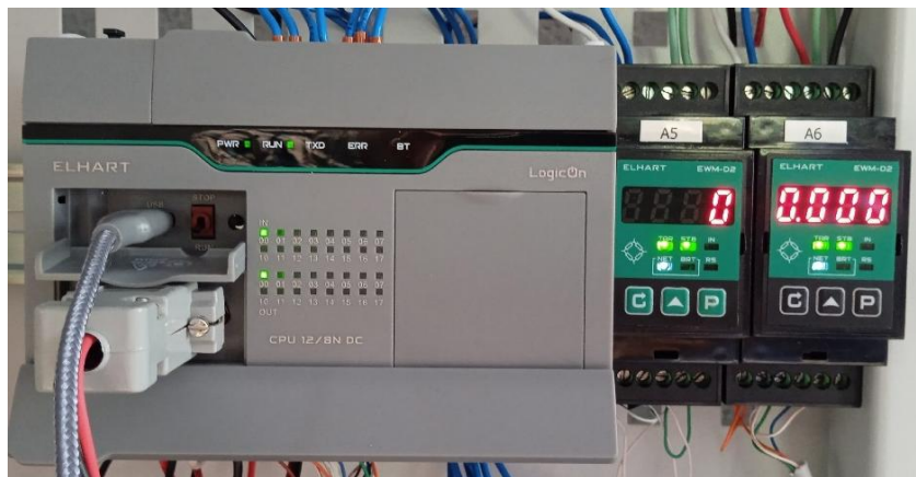
Рис. 4. Разработанный стенд на базе ПЛК LogicOnCPU 12/8NDC
