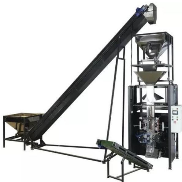
Рис. 1. Фасовочно-упаковочный автомат с весовым дозатором «СБМ»
