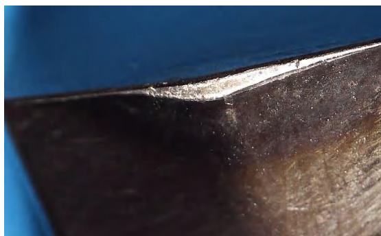
Рис. 1. Фотография износа пластины при обработке стали группы N80
