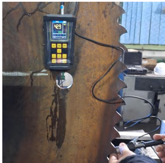
Рис. 1. Процесс замера твердости зуба пильного диска
