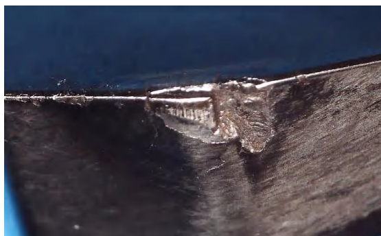
Рис. 2. Фотография износа пластины при обработке стали группы Q125
