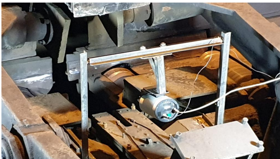
Рис. 2. Наблюдение скоростной видеокамерой за действием в процессе резания устройства, зажимающего разрезаемый прокат
