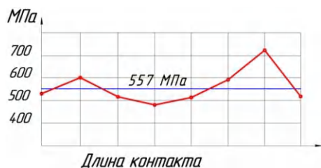
Рис. 4. Среднее напряжение в обрабатываемом материале в зоне контакта
