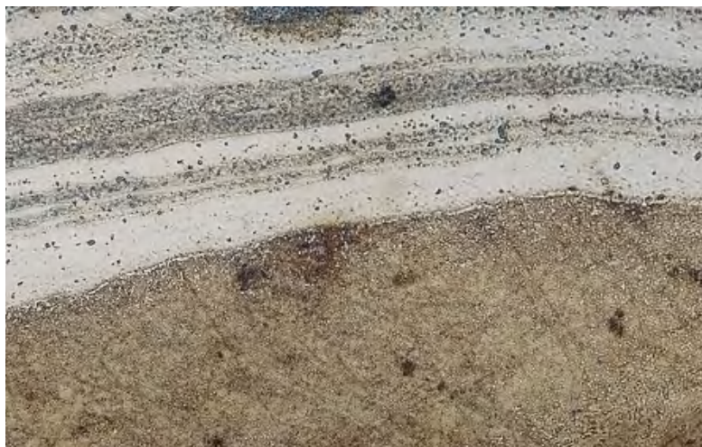
Рис. 1. Периферия зуба пилы с модифицированным контактным слоем \times 100
