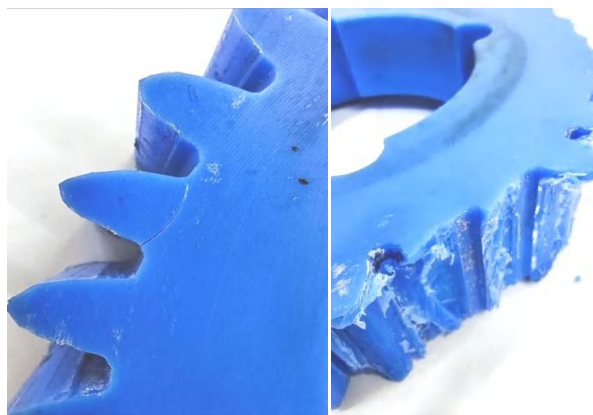
Рис. 1. Примеры сломанных зубьев и разрушения пластиковой шестерни
