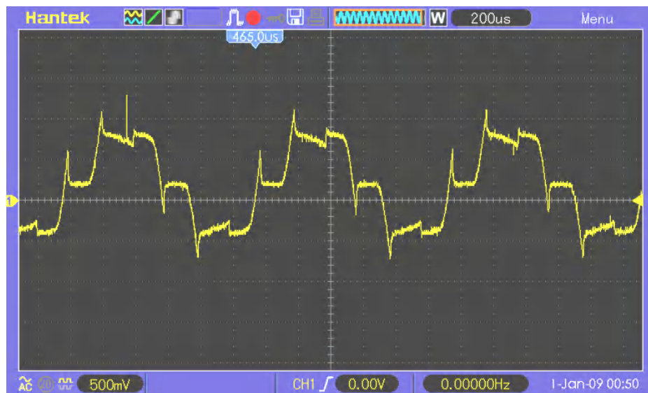
Рис. 6. Осциллограмма одной из фаз генератора
