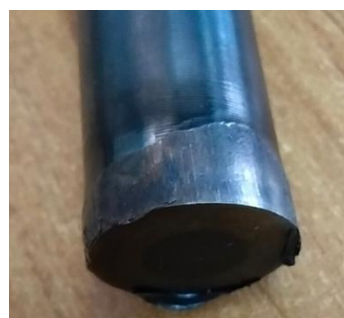
Рис. 6. Поврежденный пробивной пуансон VI позиции
