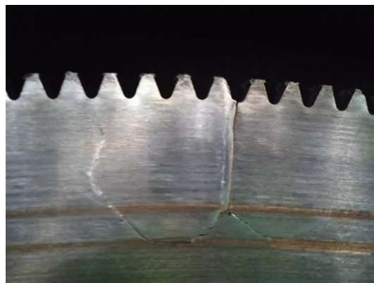
Рис. 1. Трещина во впадине зуба дисковой пилы
