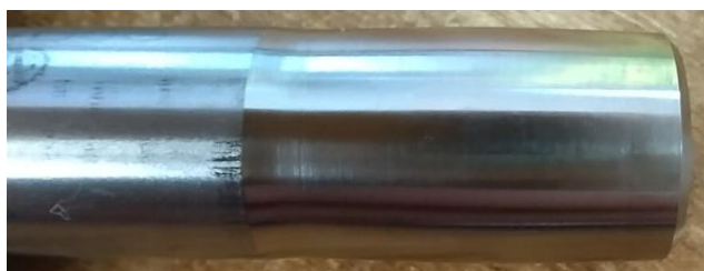
Рис. 2. Деформация, вызванная повышенным содержанием остаточного аустенита в результате нарушения технологии термической обработки
