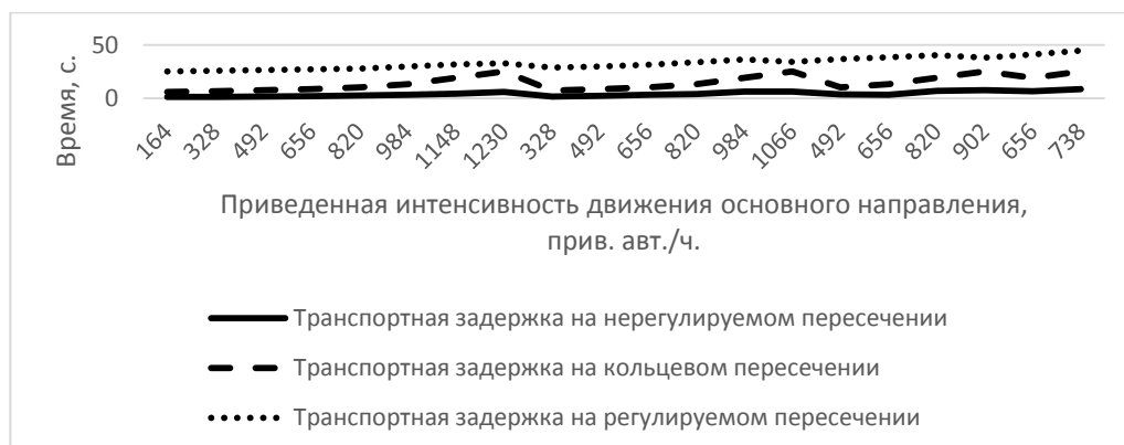
Рис. 2. Сравнительный график транспортных задержек на исследуемых типах пересечений
