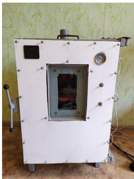
Рис. 1. Лабораторный образец литейной установки для реактопластов
