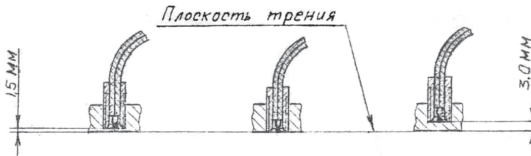
Рис. 3. Установки термопар на разных уровнях
