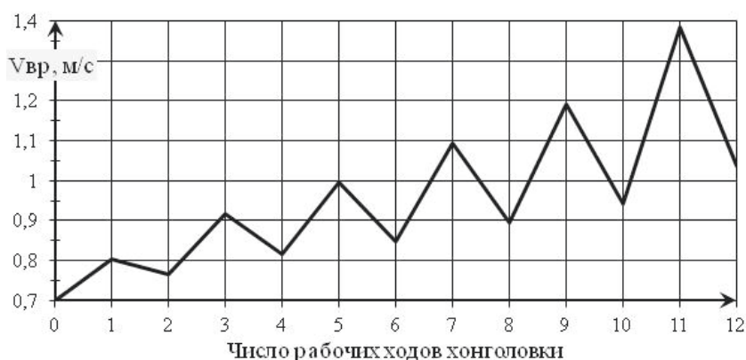
Рис. 2. Циклограмма изменения скорости вращения ( V_{вр} ) хонинговальной головки за 12 рабочих ходов (120 с. работы)
