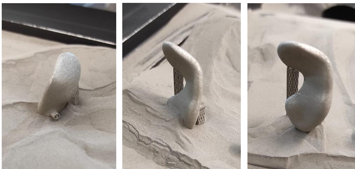
Рис. 4. Освобождение заготовки от металлического порошка
