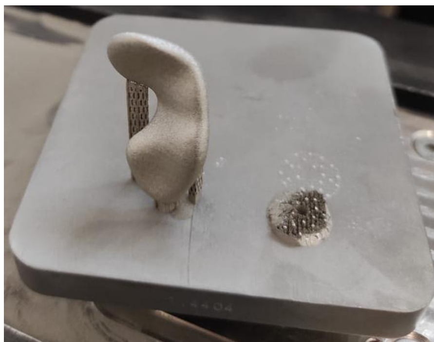
Рис. 5. Заготовка на подложках
