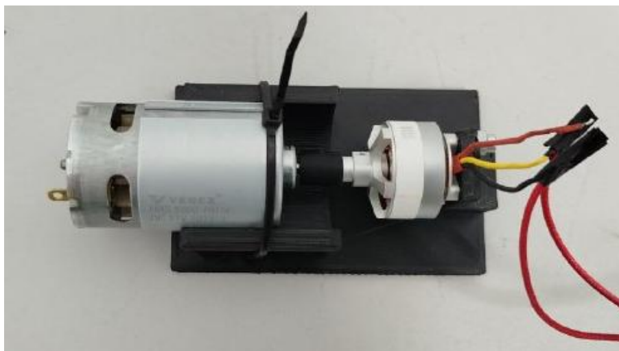
Рис. 4. Экспериментальная установка для определения КПД
