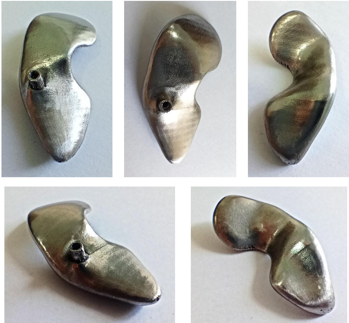
Рис. 6. Заготовка после предварительного полирования: ракурсы
