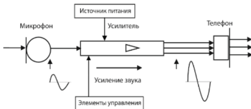
Рис. 1. Функциональная схема слухового аппарата
