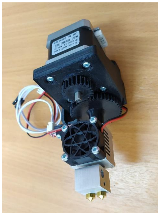
Рис. 2. Конструкция многосопельного экструдера
