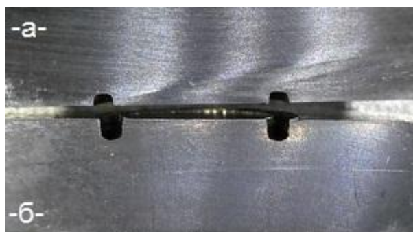
Рис. 3. Сечение канавки износа образцов сплава АМг6: а – после ЛУО; б – без ЛУО
