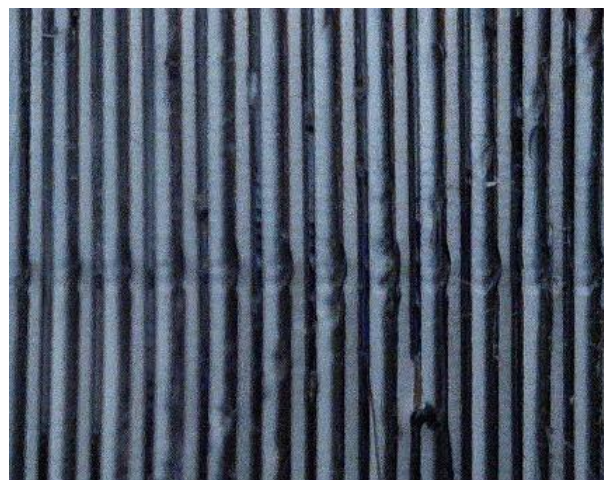
Рис. 4. Структура слоя напечатанного изделия
