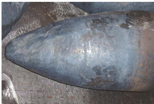
Рис. 2. Внешний вид оправки с износом рабочей части «гофра»
