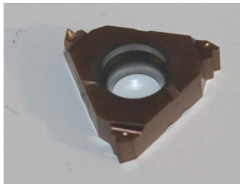
Рис. 1. Пластина для нарезания метрической наружной правой резьбы марки Sandvik Coromant
