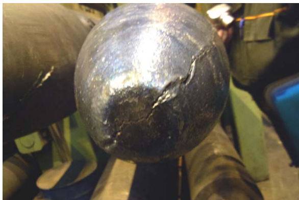
Рис. 3. Трещина напряжения в оправке непрерывного стана
