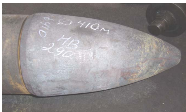
Рис. 1. Внешний вид оправки с глубокой сеткой разгара и зоной разрушения рабочей части
