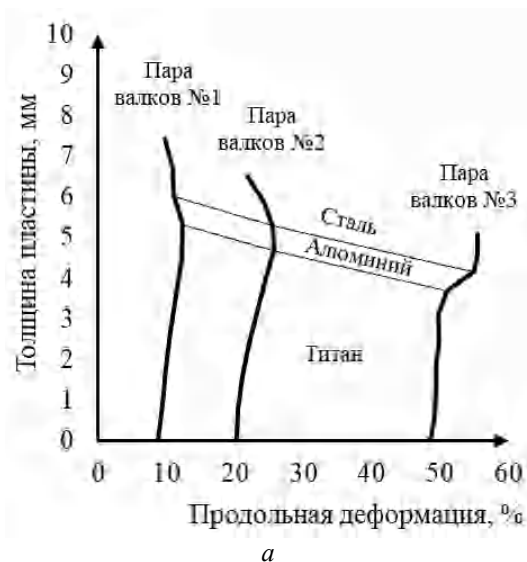
Рис. 3. Распределение продольной деформации в центральном сечении (а) и на боковой поверхности (б) асимметричного композита при последовательном прохождении образцом трех пар валков
