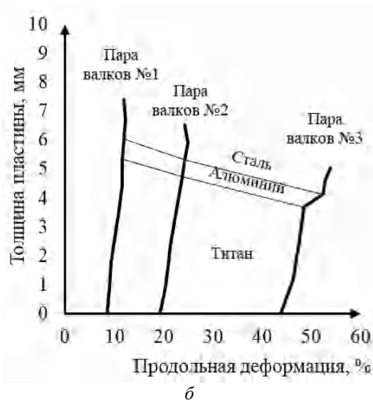
Рис. 3. Распределение продольной деформации в центральном сечении (а) и на боковой поверхности (б) асимметричного композита при последовательном прохождении образцом трех пар валков
