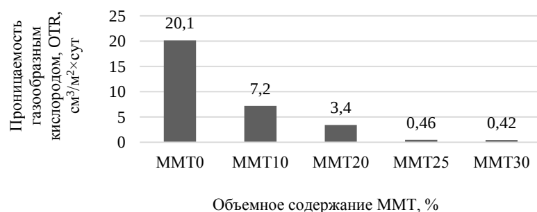
Рис. 6. Диаграмма зависимости проницаемости ламинатов газообразным кислородом от объемного содержания ММТ в нанокompозитном слое
