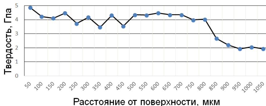
Рис. 6. Распределение микротвердости в поперечном сечении ванны переплава ( d = 2 мм, P = 1400 Вт, V = 0,8 м/мин)
