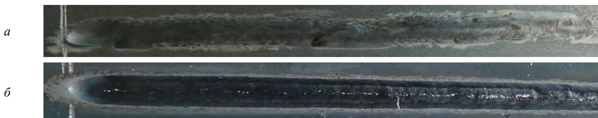
Рис. 3. Влияние ультразвука на качество катодной очистки:
