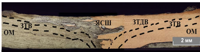
Рис. 4. Макрошлиф сварного шва алюминия и меди (режим 4)
