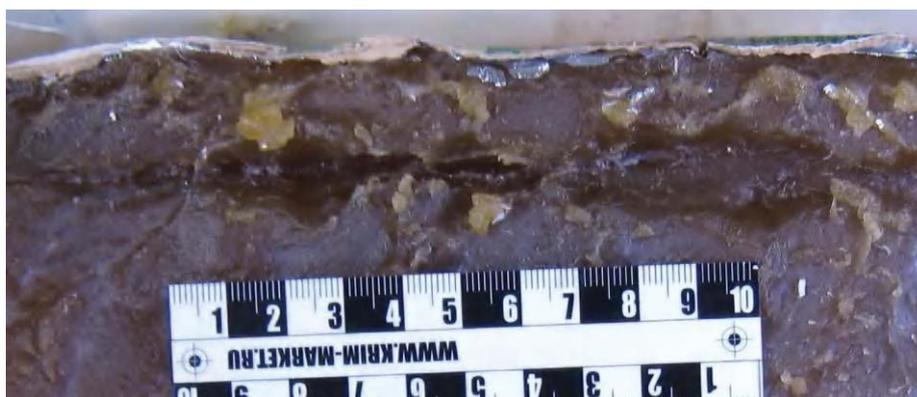
Рис. 1. Многофункциональный компаунд с огнестрельным повреждением, образованным выстреленной из пистолета Макарова пулей
