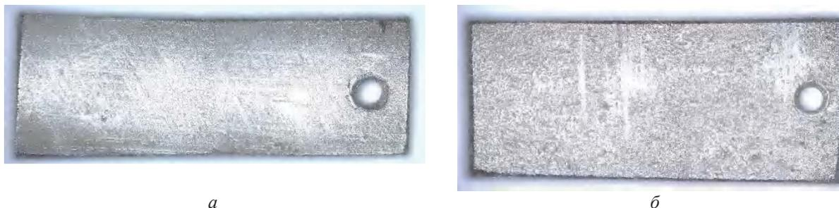
Рис. 6. Внешний вид образцов из стали 304L (а) и 316L (б) после коррозионных испытаний
