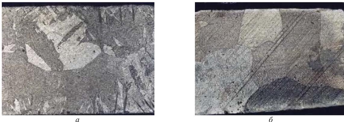
Рис. 3. Микроструктура титана VT1-0 до (а) и после многократного повторения  $\alpha \leftrightarrow \beta$ -переходов с последующим высокотемпературным отжигом (б).  $\times 50$
