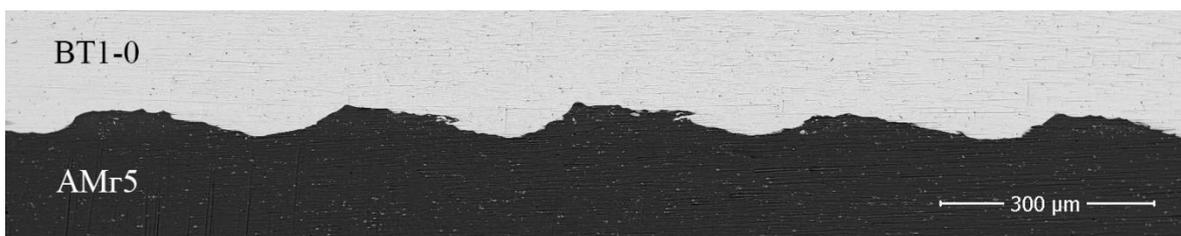
Рис. 5. Зона соединения контрольного образца
