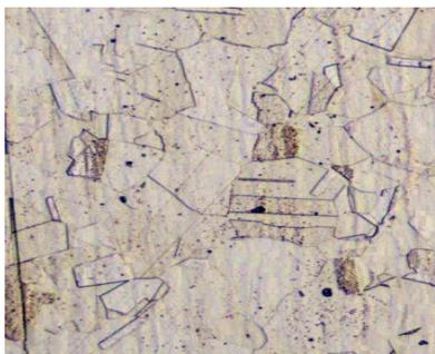
Рис. 2. Микроструктура образца № 1 с окрашенным ферритом, x200
