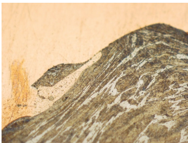
Рис. 1. Микроструктуры зоны соединения сваренного взрывом композита медь МЗ+сталь 30ХГСА. ×500
