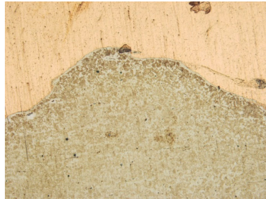
Рис. 8. Микроструктура зоны соединения биметалла после отжига. ×200
