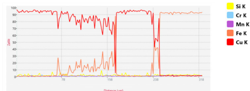
Рис. 9. Изменение распределения химических элементов по сечению вихревого участка после отжига
