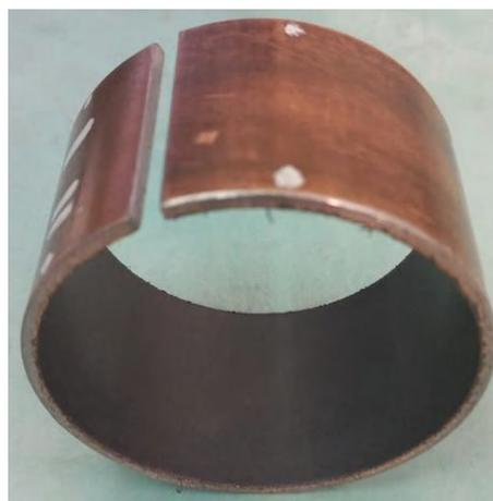
Рис. 5. Фото подшипников до испытаний
