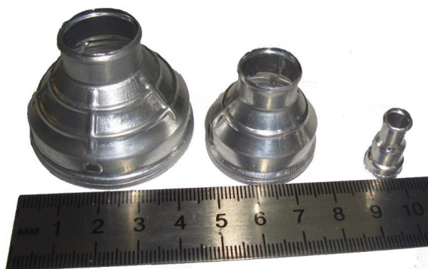
Рис. 4. Штамповарные экранирующие облегченные корпуса электросоединителей, диаметры D=10-40 мм, длины L=15-30 мм
