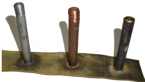
Рис. 10. Конструкция из разнородных, разнотолщинных сплавов: листовой металл из сплава Л63 толщиной 0,8 мм, стержневые элементы из сплавов АМг2,5, М1, Л63 диаметром 10 мм
