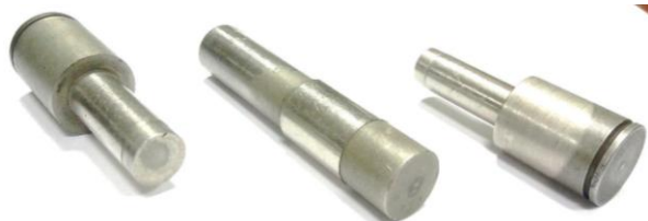
Рис. 7. Катодные узлы СВЧ ЭВП
