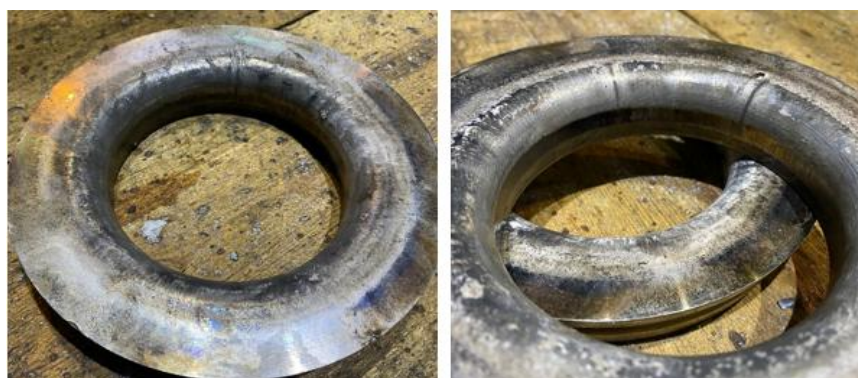
Рис. 1. Отбраковка опытных матриц производства ТПЦ-1: риски и налипание металла. Отработанные матрицы – 6 прессований
