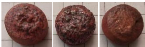
Рис. 2. Пеномедные образцы диаметром 10 мм с порофором \text{CaCO}_3
