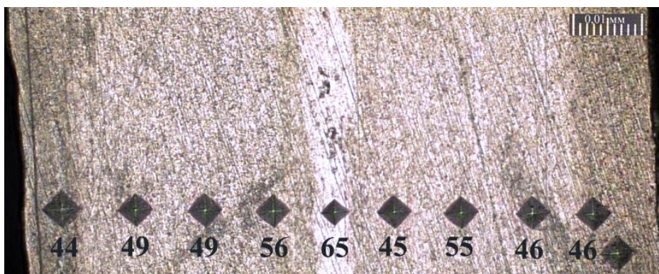
Рис. 3. Микротвердость HV в зоне соединения и околошовной зоне алюминиевой фольги марки ДПРХМ
