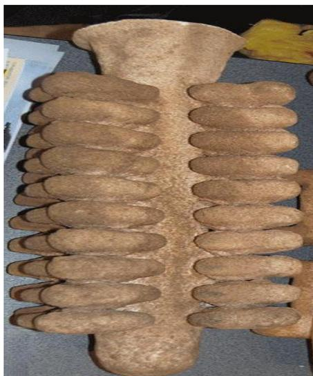
Рис. 2. Вид формооболочки с экспериментальными отливками
