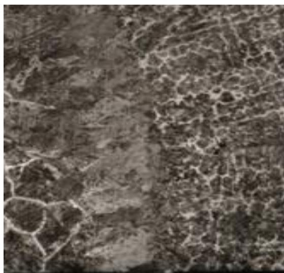
Рис. 5. Микроструктура отливок из стали 45Л с поверхностным легированием углеродом. Литое состояние
