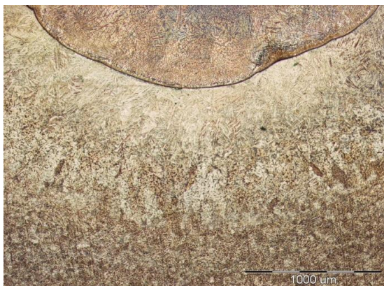
Рис. 1. Структура ЗВ и ЗТВ после однократной лазерной обработки биметалла МН19+ВТ1-0
