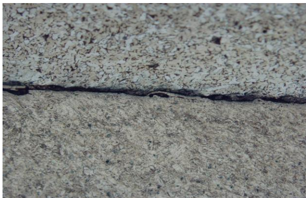
Рис. 3. Микроструктура зоны соединения титан BT1-0 + сталь 08 кп после сварки взрывом ( \times 200 )
