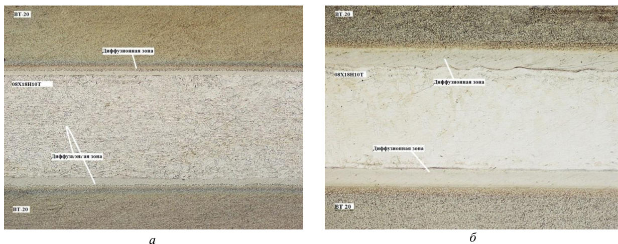
Рис. 1. Микроструктура сваренного взрывом титано-стального КМ после термообработки (см. также с. 16): а, б – 850 и 900 °С, время выдержки 20 ч; в, г – 850 и 900 °С, время выдержки 50 ч; д, е – 850 и 900 °С, время выдержки 100 ч. *50
