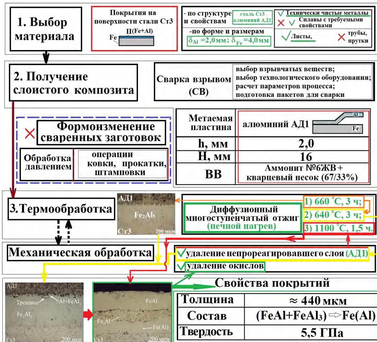
Рис. 1. Технологическая схема получения покрытий системы Fe-Al [8]
