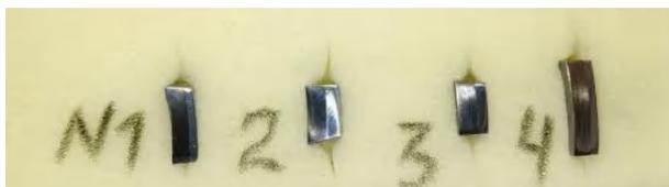
Рис. 3. Образцы для изучения микротвердости (темный слой – ВТ1, светлый – АМг2)
