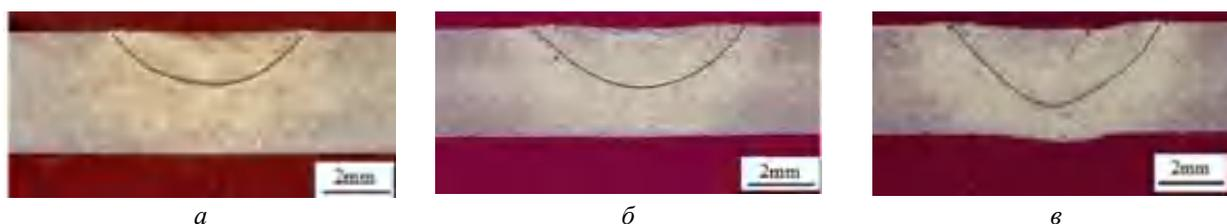
Рис. 1. Влияние мощности УЗК на глубину проплавления:
