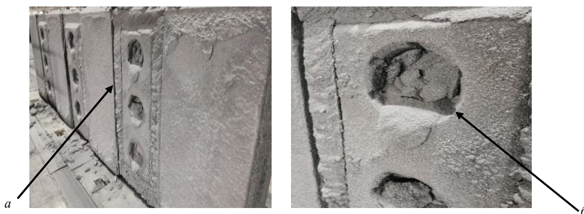
Рис. 3. Дефекты обожженных анодов: a – прикоксовка анодов; б – дефекты nippleных гнезд
