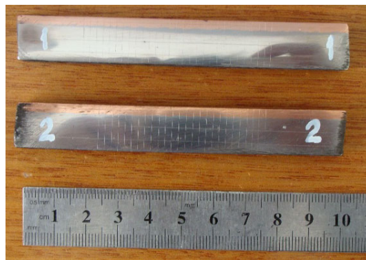
Рис. 1. Сетка реперных линий на боковых поверхностях медно-стальных образцов для определения распределения деформаций после испытаний на изгиб
