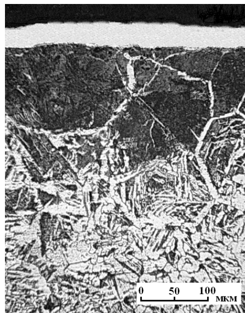
Рис. 2. Микроструктура стали 20 после микродугового ванадирования
