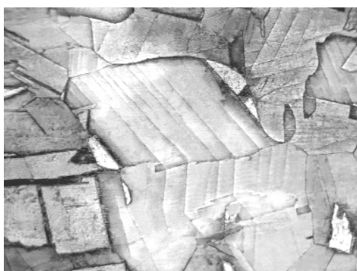
Рис. 1. Эстафетная передача скольжения через границу зерен меди после лазерной обработки
