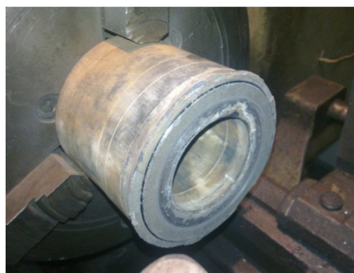
Рис. 3. Токарная обработка поверхности опытной заготовки (КХТ-30)
