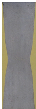
Рис. 2. Формоизменение сплошного образца при разных удлинениях
