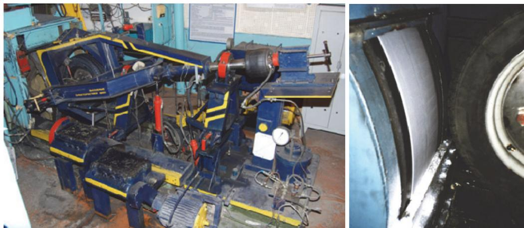
Рис. 2. Барабанный стенд с ледяным покрытием [17]
