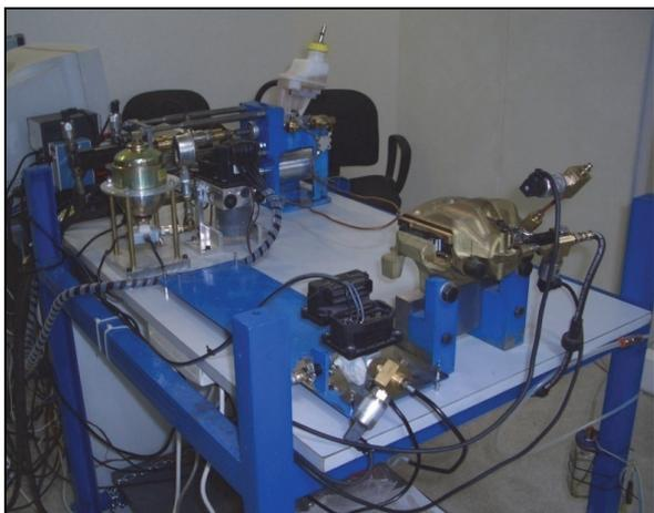
Рис. 3. Стенд для испытания ЭГТС (для одного контура колеса)
