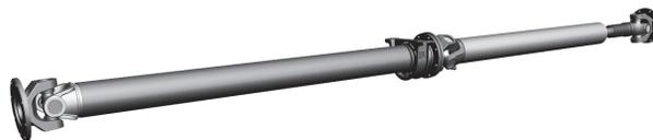
Рис. 1. Конструкция карданной передачи автобуса «Волжанин-4298»
