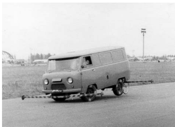
Явление отрыва заднего колеса автомобиля-фургона в процессе экстренного торможения на поверхности типа «сухой асфальтобетон»
