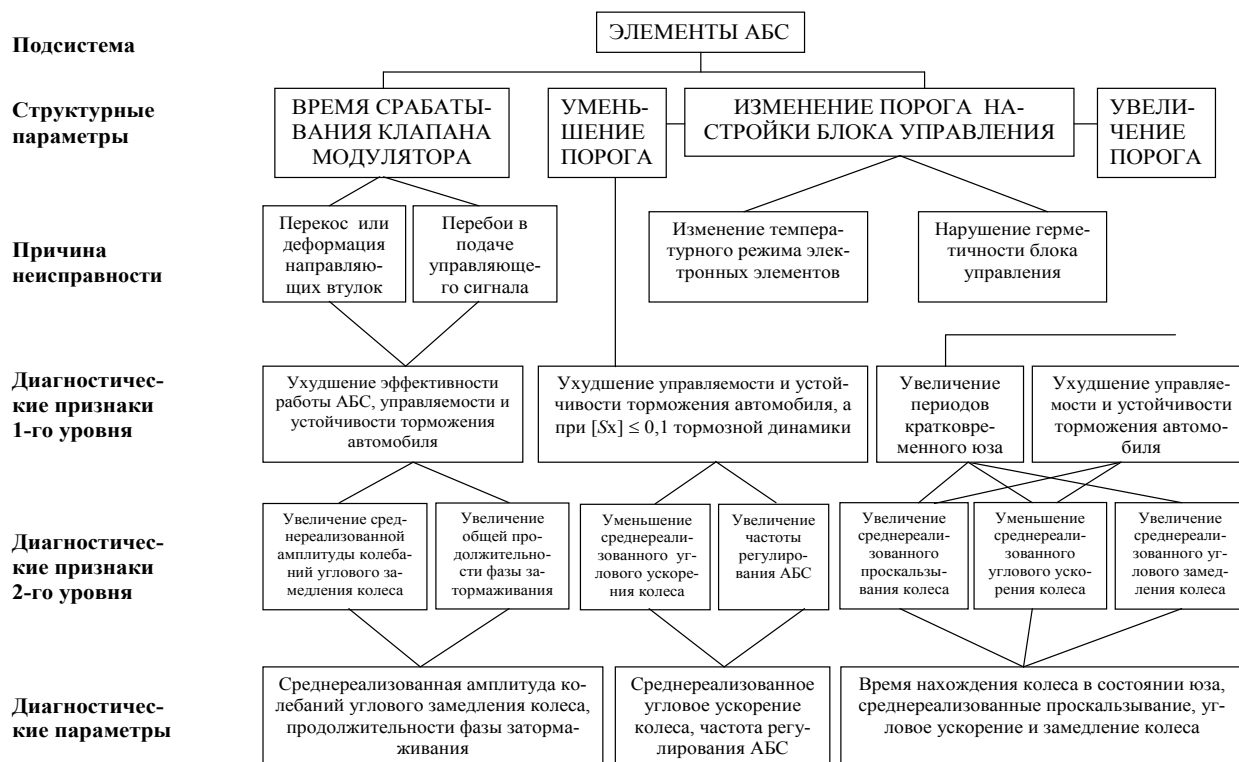
Структурно-следственная схема для диагностирования элементов АБС автомобиля с пневматической тормозной системой
