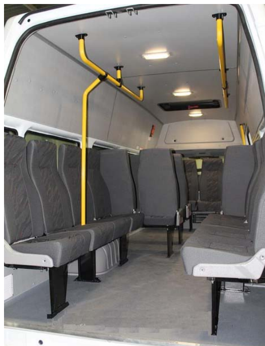
Рис. 2. Вид сидений, установленных перпендикулярно к направлению движения микроавтобуса Ford Transit
