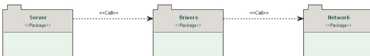
Рис. 1. Часть диаграммы пакетов ПО серверной части системы управления «умным домом»
