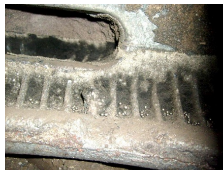
Рис. 4. Фрагмент отливки «Опора» с охлаждающими ребрами
