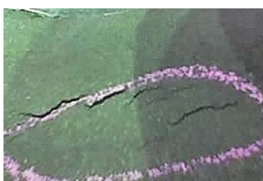
Рис. 6. Трещина, прерывистая на равной по толщине стенке отливки
