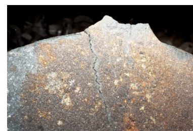
Рис. 7. Трещина, изломанная у увеличенного питателя
