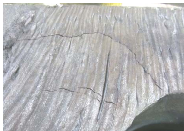
Рис. 2. Фрагмент отливки «Корпус 232» с трещинами
