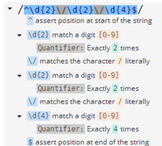
Рис. 1. Объяснение выражения ^\d{2}\/\d{2}\/\d{4}$ с помощью приложения regex101
