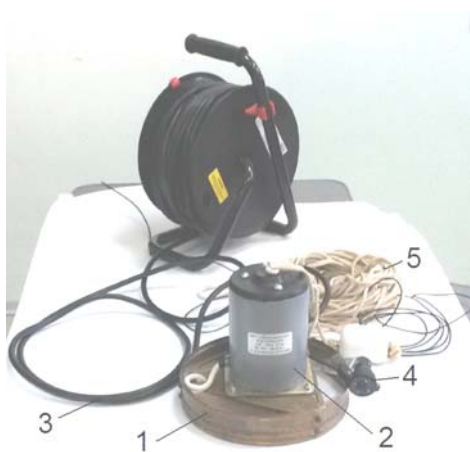
Рис. 1. Штамповая установка для исследования компрессионного эффекта на подводных грунтах: 1 – рама; 2 – электромагнит; 3 – кабель-трос; 4 – подводная видеокамера; 5 – страховочный линь
