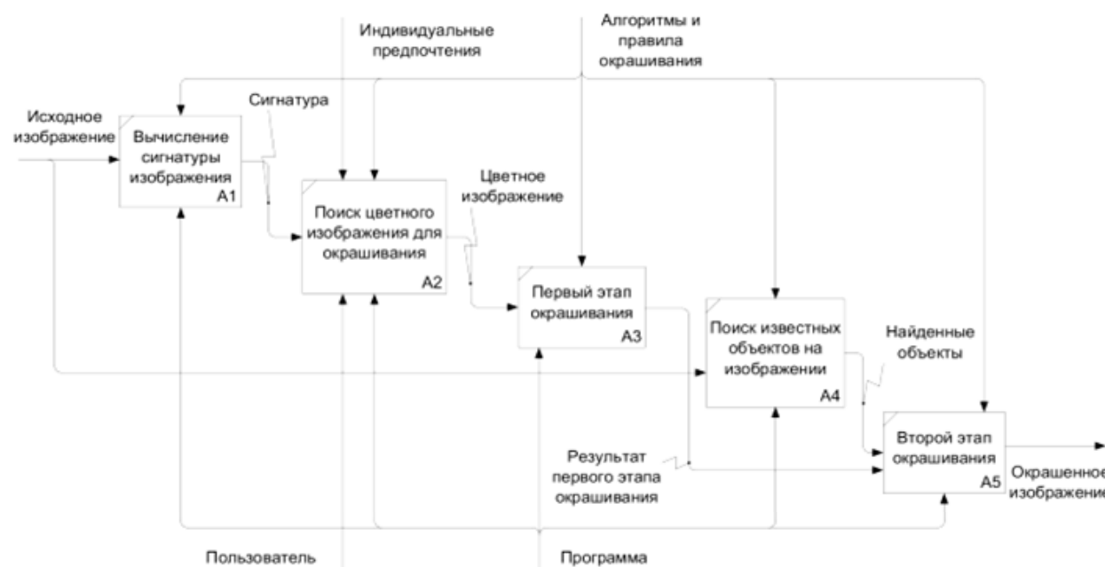
Рис. 2. Процесс окрасивания в нотации IDEF0 (to be)
