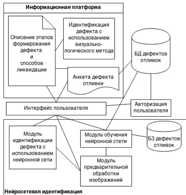
Рис. 1. Архитектура автоматизированной системы диагностики и ликвидации литейных дефектов
