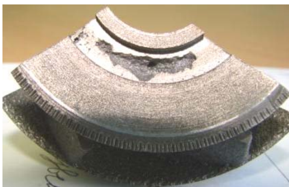
Рис. 4, а. Фрагмент отливки «Рабочий орган» с окисленной газовой раковиной
