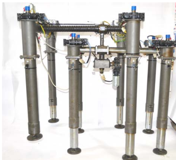
Рис. 3. Шагающий ортогональный движитель с датчиками обратной связи
