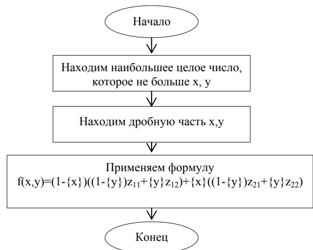
Рис. 2. Схема алгоритма билинейной фильтрации
