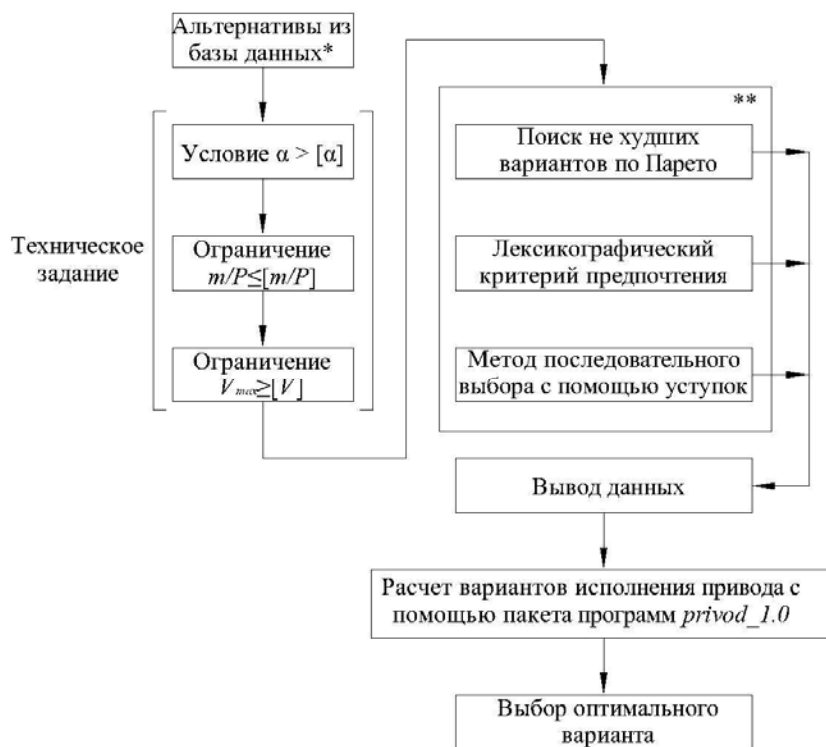
Рис. 5. Алгоритм выбора привода для зеркальной антенной системы:
