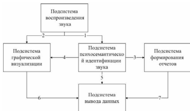
Рис. 2. Функциональная схема проектируемой системы: 1, 2 – дискреты аудиосигнала; 3 – психологическая характеристика аудиокомпозиции; 4 – музыкальные ноты; 5 – графическая информация; 6 – когнитивная карта аудио композиции; 7 – текстовая и графическая информация
