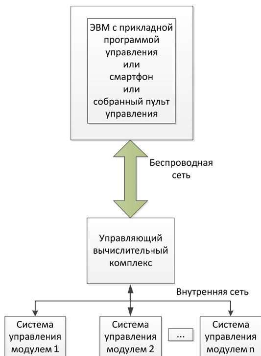
Разработанная архитектура мобильного робота
