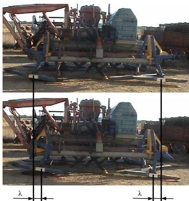
Рис. 5. Изменение положения опорной точки механизмов шагания
