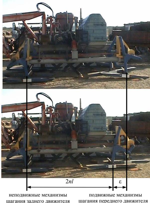
неподвижные механизмы шагания заднего движителя      подвижные механизмы шагания переднего движителя
