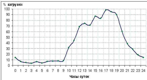
Рис. 1. Изменение нагрузки на УК УЦ в течении суток
