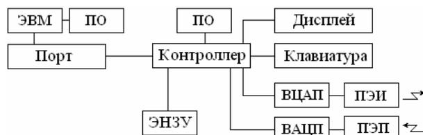
Рис. 12. Структурная схема первичного преобразователя измерительной системы
