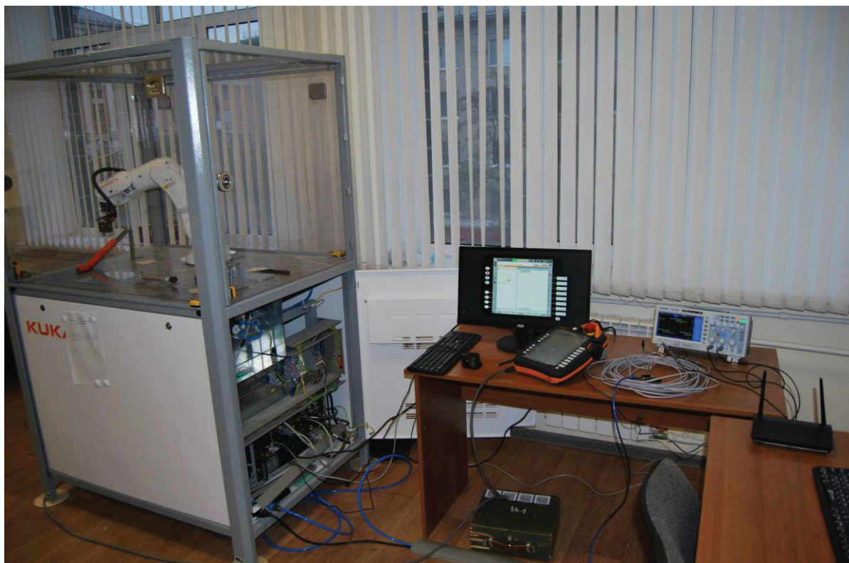
Рис. 2. Экспериментальная установка на базе промышленного робота Kuka с системой управления KRC4 Compact
