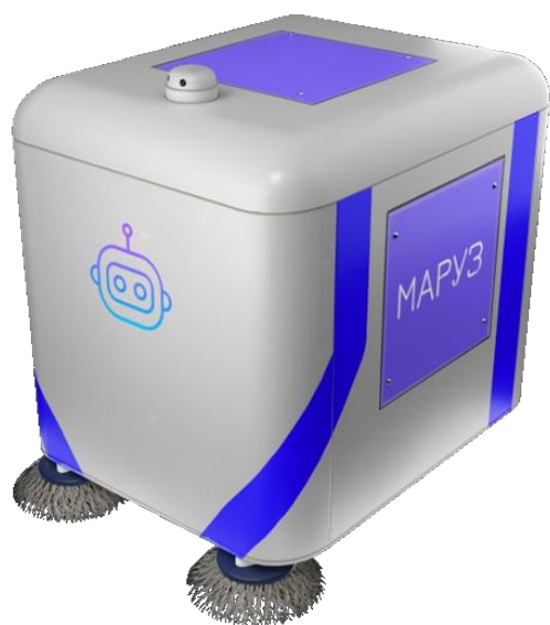
Рис. 2. Робот для уборки зернохранилищ
