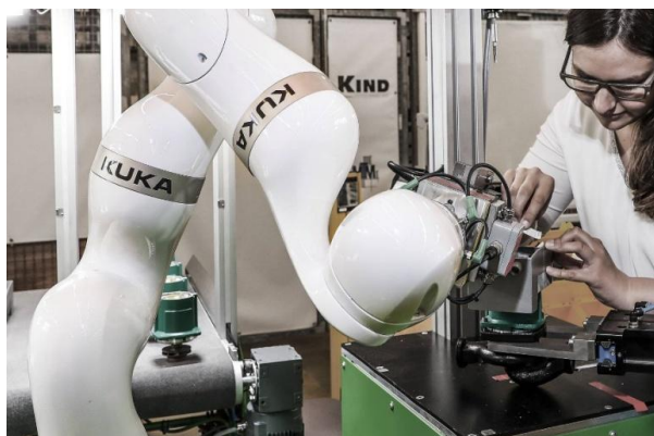
Рис. 4. Совместное выполнение сборочно-монтажных операций с помощью МИСП
