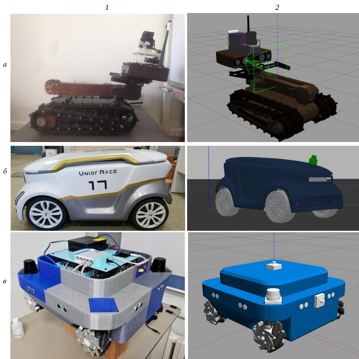
Рис. 3. Натурные РТС (1) и их виртуальные модели для Gazebo (2): «Сервосила Инженер» (а), «Аврора Юниор» (б), «ArtBul-2» (в)
