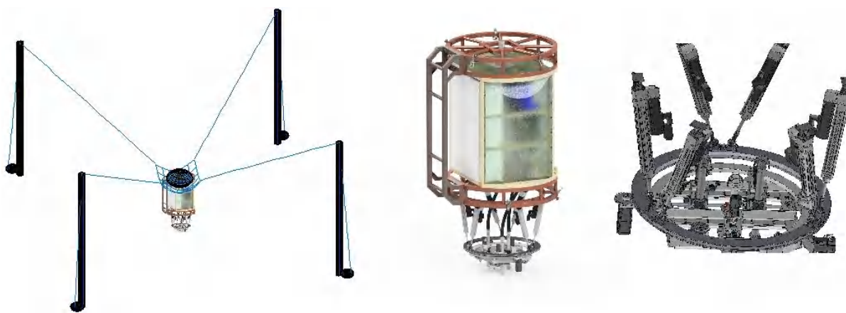
Рис. 1. Схематичное изображение пространственного четырехтросового параллельного робота и модели рабочего инструмента с использованием платформы Стюарта (Университет Иннополис)
