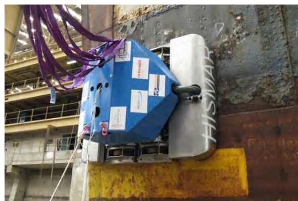
Рис. 4. Прототип автономного робота для очистки корпусов судов HISMAR
