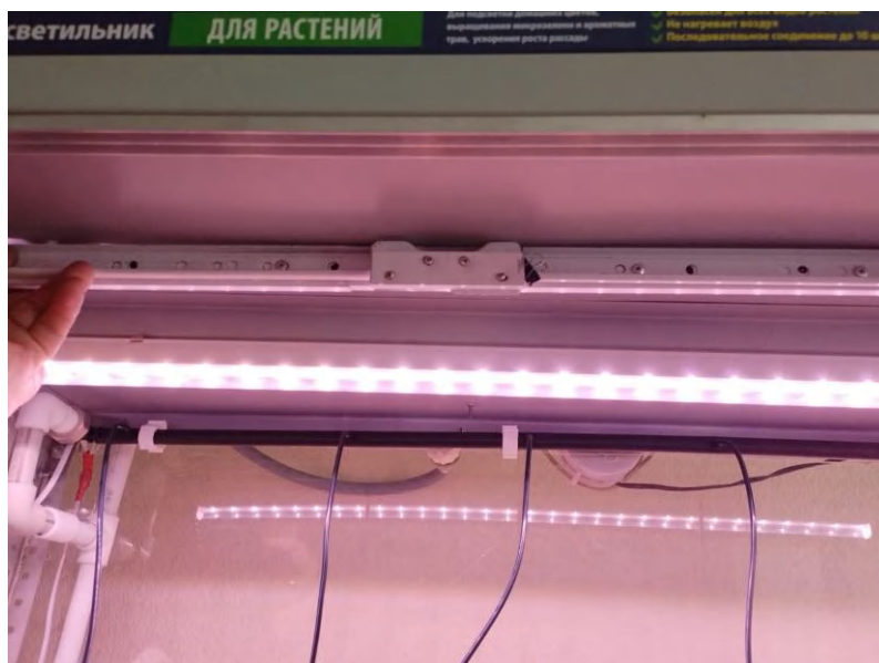
Рис. 2. Светодиодный светильник системы регулируемого спектрального освещения фитотрона
