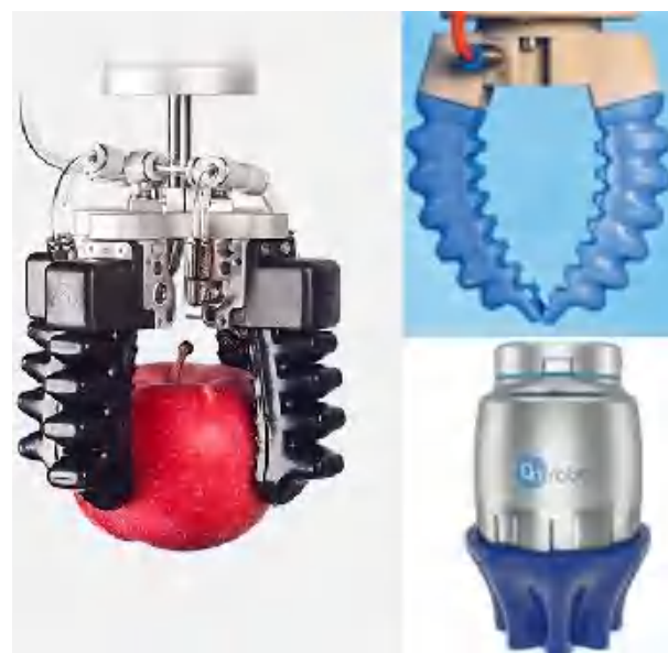
Рис. 5. Промышленные захватные устройства с силиконовыми рабочими элементами различных конструкций
