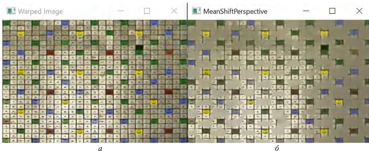
Рис. 6. Реализация алгоритма перспективного преобразования (а) и сегментации (б)
