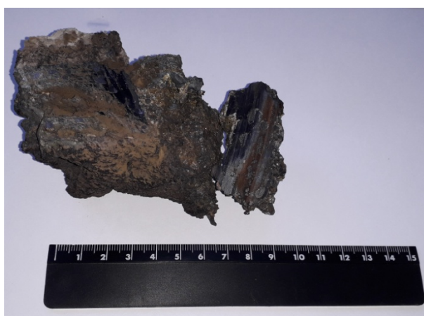
Металлизация футеровки индукционной тигельной печи
