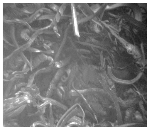
Рис. 1. Внешний вид стружки после абразивной зачистки металлопроката стали 12Х18Н10Т
