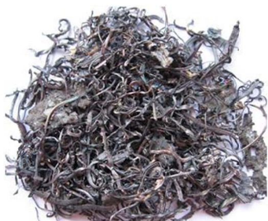
Рис. 1. Внешний вид стружки после абразивной зачистки металлопроката стали 12Х18Н10Т
