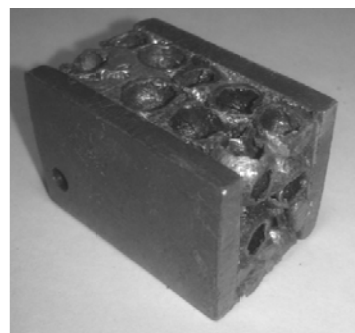
Рис. 3. Вид образца для испытания, полученного после заливки алюминием, с простым кубическим расположением сфер
