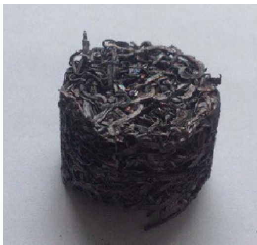
Рис. 2. Брикет из отходов абразивной зачистки стали 12X18H10T
