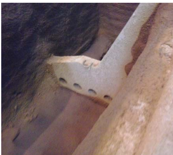
Рис. 3. Компонка порога с ПОО разливочной камеры промежуточного ковша МНЛЗ
