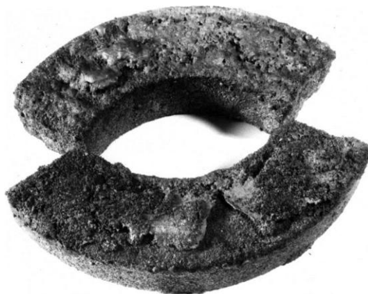
Рис. 1. Общий вид кусков самосвязанного карбида кремния после высокотемпературных испытаний
