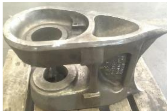
Рис. 3. Отливка «Корпус подшипников», форма ХТС, 7 класс точности. Материал – сталь 20ГЛ; t_{зал} = 1660\text{ }^{\circ}\text{C} ; t_{лик} = 1488\text{ }^{\circ}\text{C} ; t_{сол} = 1413\text{ }^{\circ}\text{C} ; t_{лик} - t_{сол} = 75\text{ }^{\circ}\text{C} . Время затвердевания тонкого сечения 17 мин, массивного – 21 мин
