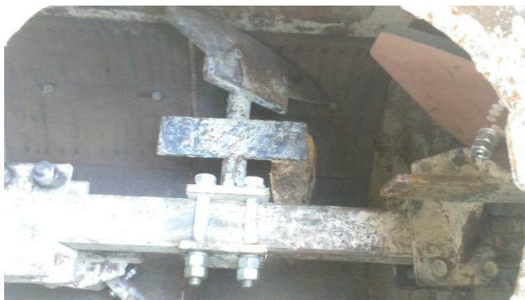
Рис. 2. Расположение лопаток в резервуаре смесителя
