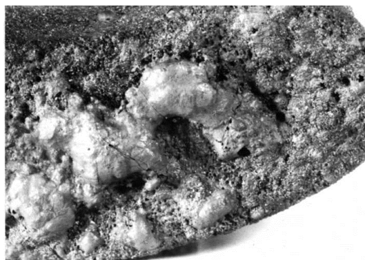
Рис. 2. Поверхность самосвязанного карбида кремния с расплавленной окалиной, \times 2
