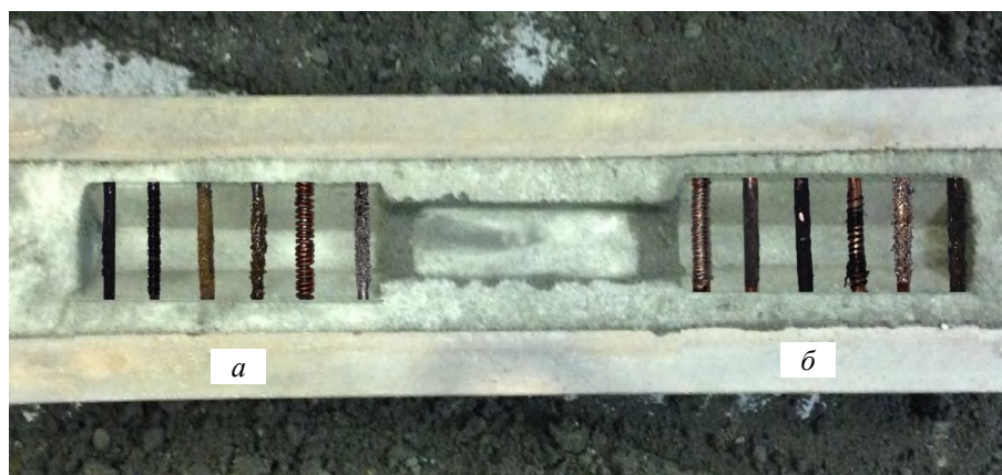
Рис. 3. Вид сверху на нижнюю полуформу с проставленными экспериментальными стержнями: а – стальной стержень; б – медный стержень
