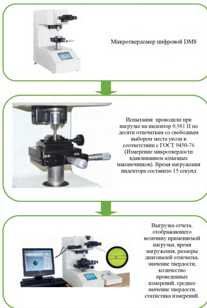
Рис. 2. Структурно-логическая схема методики исследования микротвердости аддитивного образца
