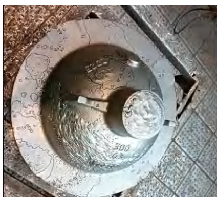
Рис.1. Фото дефектов на высоколегированной аустенитной стали
