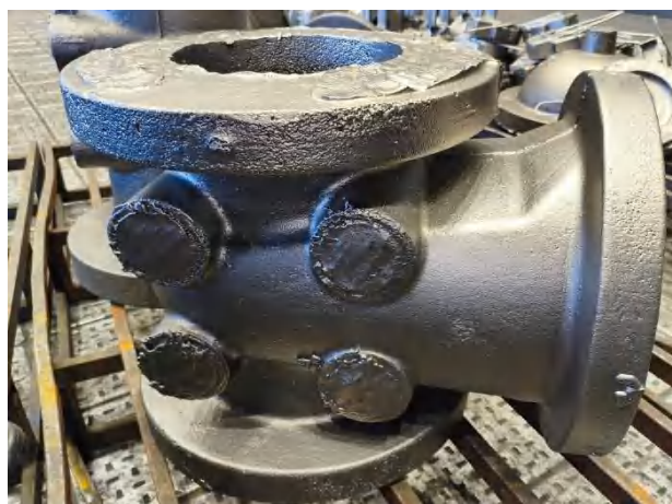
Рис. 2. Отливка «Корпус» после проведения термообработки (1 этап)
