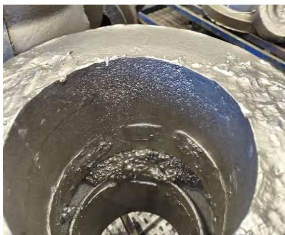
Рис. 2. Отливка «Корпус» после проведения термообработки (1 этап)
