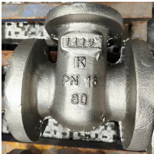
Рис. 4. Отливка «Корпус» после проведения термообработки (3 этап)
