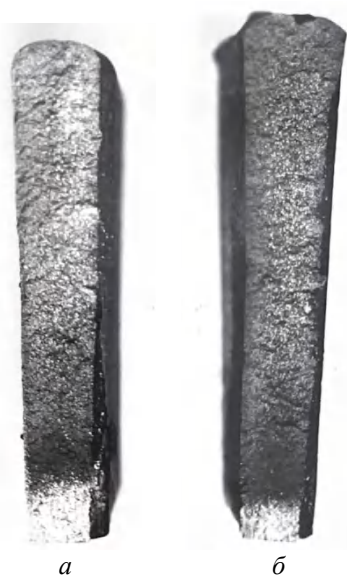
Рис. 3. Отбеленный чугун в клиновидной пробе: а – немодифицированный чугун; б – модифицированный чугун
