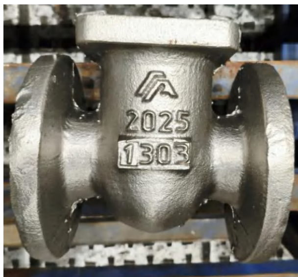
Рис. 3. Отливка «Корпус» после проведения термообработки (2 этап)
