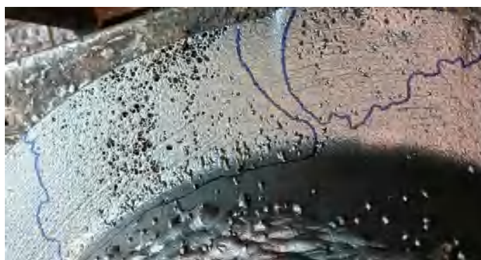
Рис.1. Фото дефектов на высоколегированной аустенитной стали
