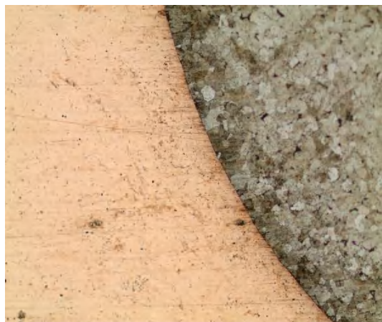
Рис. 4. Сплавление чугуна со сталью через слой меди
