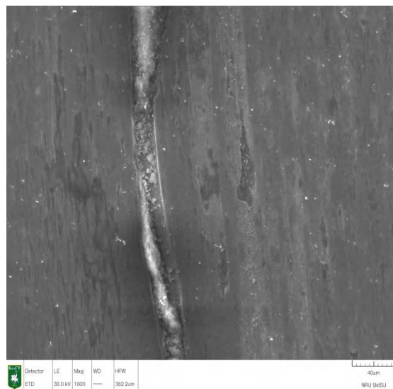
Рис. 5. Микрофотография дорожки износа на образце № 2
