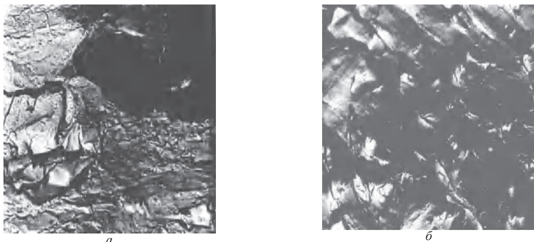
Рис. 4. Излом по дефекту: а – транскристаллитные сколы со следами квазиотрыва; б – чашечного строения, х 5000
