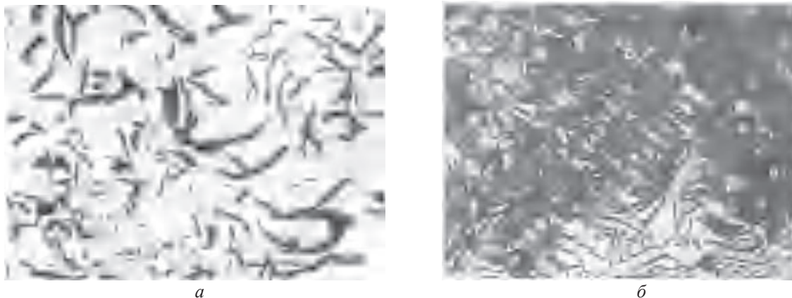
Рис. 2. Микроструктура отливки из чугуна второй плавки в стенке толщиной 60 мм: а – графитовая фаза, нетравленный шлиф, \times 100 ; б – перлит и феррит \sim 35\% в металлической основе, \times 100
