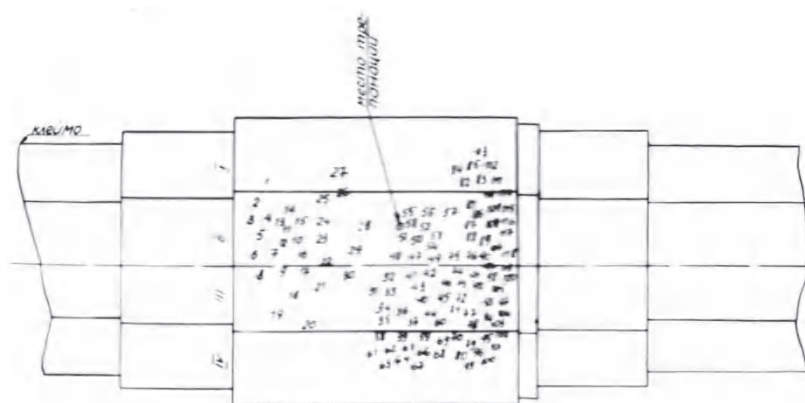
Рис. 1. Схема расположения дефектов, выявленных при УЗК в поковке роторного вала марки 35ХН1МА (масса слитка 71,5 т)
