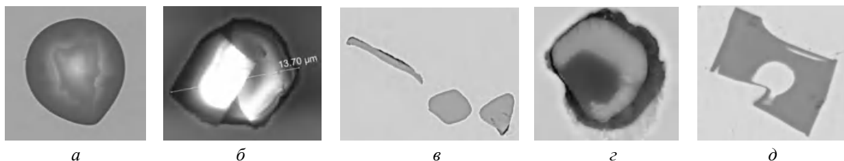
Рис. 1. Характерные НМВ, выявленные в НЛЗ, х10000: а – силикатные включения типа 3\text{MnO} \cdot \text{Al}_2\text{O}_3 \cdot 3\text{SiO}_2 ; б – алюмомagneзиальная шпинель \text{Al}_2\text{O}_3 \cdot \text{MgO} в оболочке алюмината кальция \text{CaO} \cdot \text{Al}_2\text{O}_3 ; в – сульфидные включения
