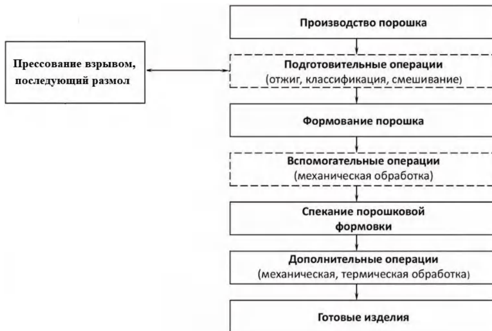
Рис. 1. Технологическая схема получения металлополимерных заготовок методом порошковой металлургии
