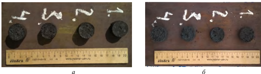
Рис. 1. Внешний вид экспериментальных брикетов из замасленной окалины: а – после сушки; б – после обжига
