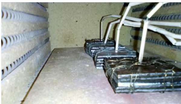
Рис. 2. Расположение четырех стоп листов с установленными хромель-алюмелевыми термопарами в камерной электрической муфельной печи
