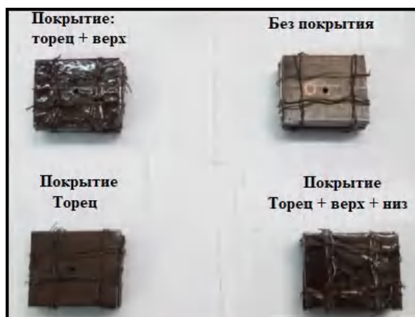
Рис. 1. Стопы листов из стали 3 с защитным покрытием жидкого стекла
