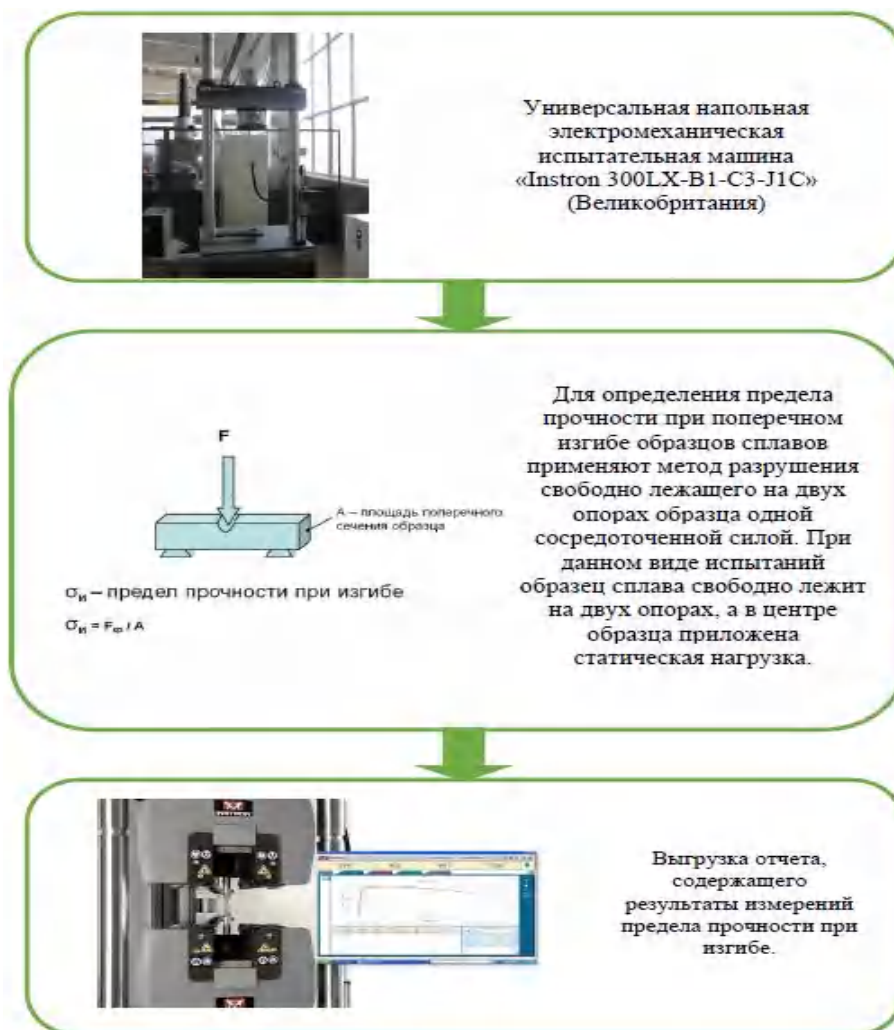
Рис. 2. Блок-схема методики исследования предела прочности при поперечном изгибе
