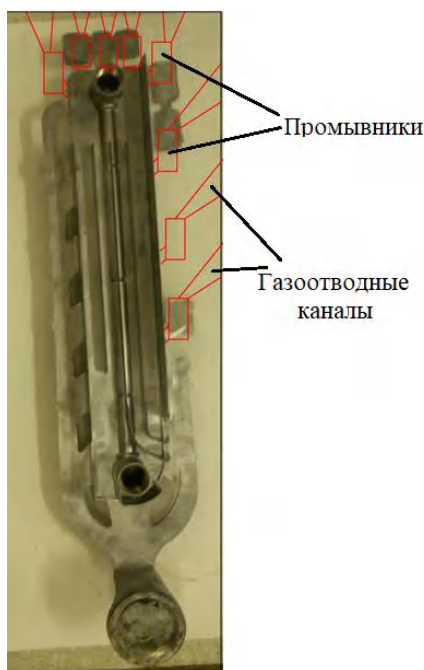
Рис. 6. Рекомендуемая схема расположения промывников и газоотводных каналов
