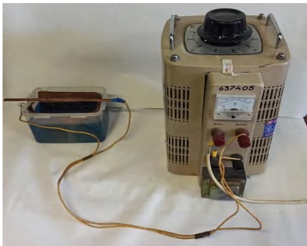
Рис. 2. Общий вид гальванической установки для нанесения металлического покрытия
