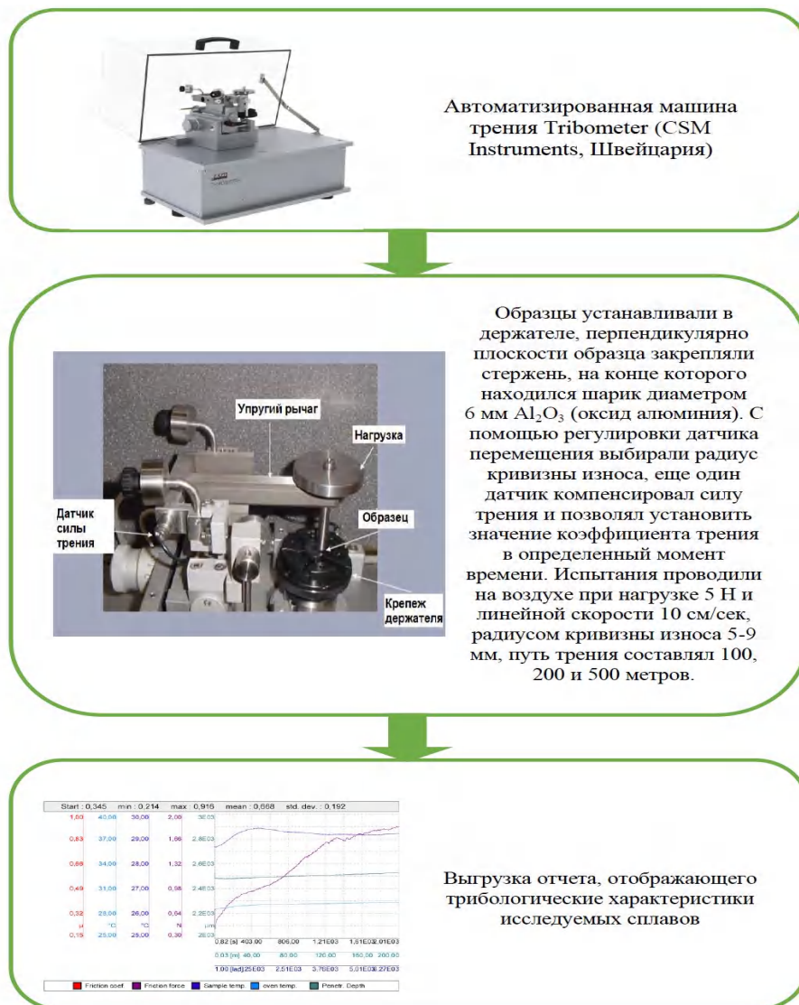
Рис. 3. Блок-схема методики исследования износостойкости сплавов
