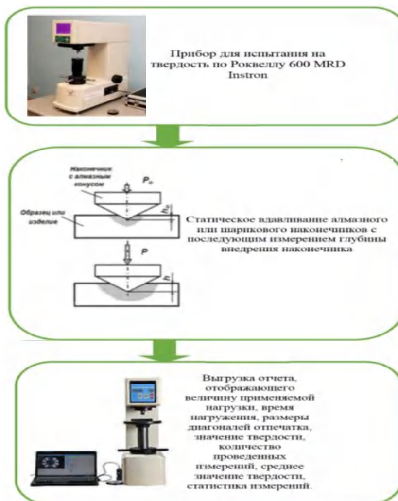
Рис. 1. Блок-схема методики исследования твердости по Роквеллу
