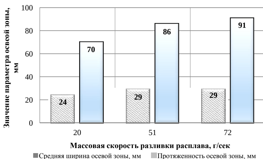
Рис. 3. Изменение протяженности и средней ширины осевой зоны модельных слитков
