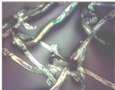
Рис. 1. Микрофотографии волокон в клеевой пленке при 50-кратном увеличении
