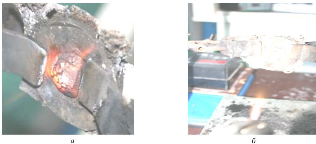
Рис. 2. Вид поверхности кокса при воздействии на образец пламени горелки: а – карбид кремния; б – перлит
