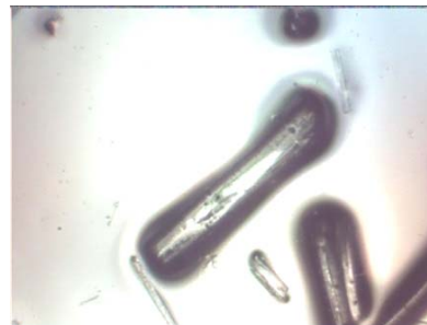
Рис. 1. Микрофотографии волокон в клеевой пленке при 50-кратном увеличении
