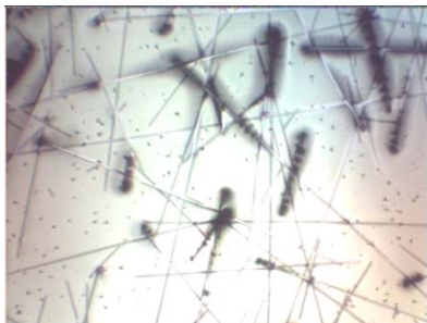
Рис. 1. Микрофотографии волокон в клеевой пленке при 50-кратном увеличении
