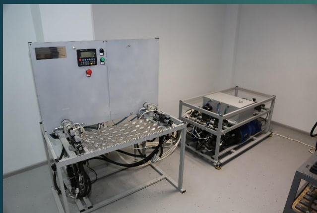
Многоканальный электрогидравлический следящий резервированный привод
