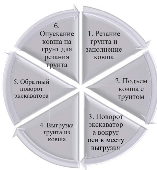
Рисунок 1.1 - Цикл действия одноковшового экскаватора при разработке грунта
