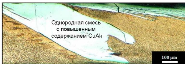
Рисунок 1.7 – Структура сварного шва без активного перемешивания [11]
