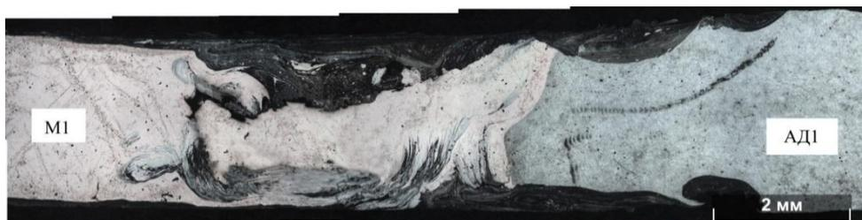
Рисунок 4.12 – Макрошлиф двухстороннего сварного шва ( $\omega = 900$  об/мин,  $v = 25$  мм/мин,  $\alpha = 3^\circ$ )
