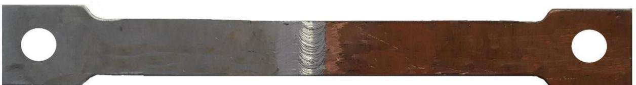
Рисунок 4.19 – Токоведущая шина для трансформаторной станции
