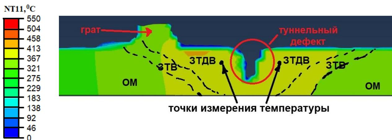
Рис. 3.19 – Визуализация полученного при моделировании распределения температуры в зоне сварного шва при *режиме 2* (800 об/мин, 25 мм/мин, 3°, смещение 1 мм на медь) [131]
