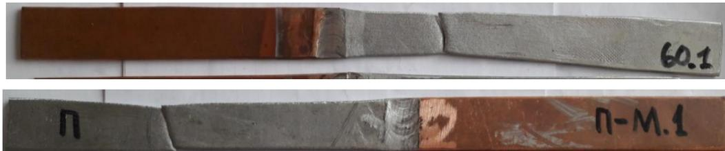
Рисунок 4.15 – Общий вид образцов после испытания на разрыв
