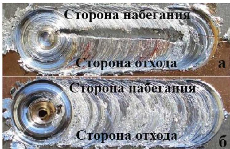
Рисунок 1.10 – Поверхность образцов при позиционировании свариваемых материалов: а – медь на стороне отхода; б – алюминий на стороне отхода [69]
