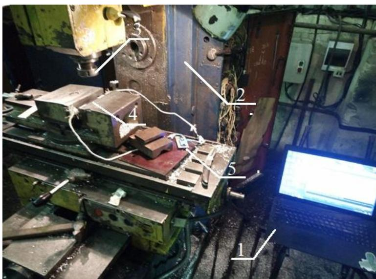
Рисунок 2.9 – Установка для определения термических циклов при СТП: 1 – персональный компьютер; 2 – станок 6Т80Ш; 3 – СИ; 4 – термопары; 5 – прибор для измерения температуры
