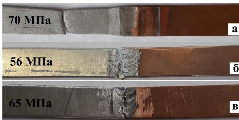
Рисунок 3.24 – Фотографии сварных соединений после испытания на разрыв трех образцов, вырезанных из одной пластины сваренного СТП соединения АД1 и М1:
