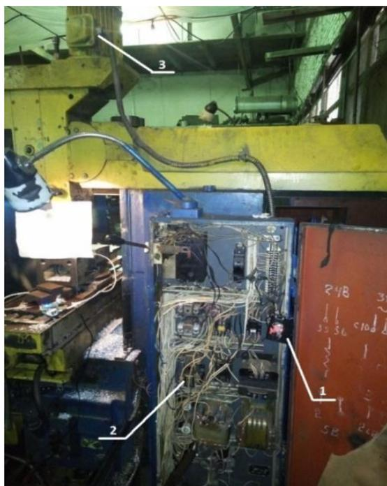
Рисунок 2.6 – Расположение подключенного устройства для измерения энергетических характеристик процесса СТП: 1 – датчик силы тока; 2 – тепловое реле; 3 – электродвигатель
