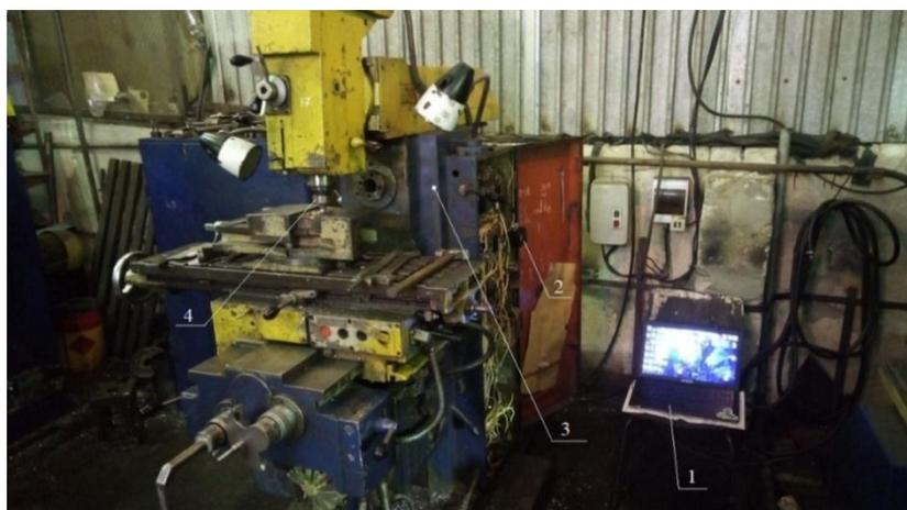
Рис. 2.1 – Установка для экспериментов по СТП: 1 – универсальный фрезерный станок 6Т80Ш с закрепленным образцом; 2 – сварочный инструмент; 3 – устройство для регистрации энергетических характеристик; 4 – персональный компьютер
