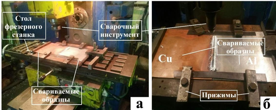
Рисунок 4.17 – Фрезерный станок 6Т80Ш (а) и приспособление для закрепления (б) алюминиевых и медных пластин
