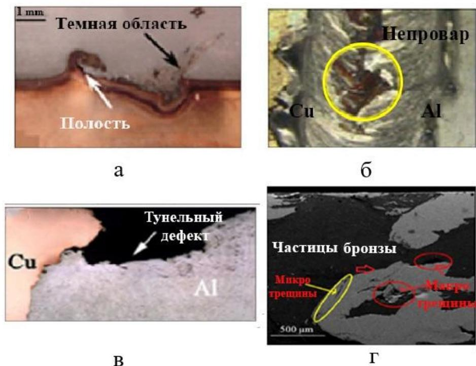
Рисунок 1.15 – Распространенные дефекты сварного шва при СТП: а – полость и микротрещина нахлесточного соединения Al1060 и чистой меди [45]; б – внешняя трещина соединения AA6063 и чистой меди [68]; в – туннель соединения в стык Al1060 и чистой меди [78]; г – микротрещина и включения соединения в стык Al1050 и латуни [90]
