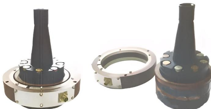
Рисунок 2.10 – Вращающийся датчик четырёхкомпонентный М44 для определения усилия и вращающегося момента при СТП [126]
