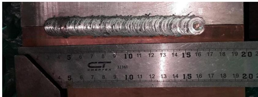
Рисунок 4.18 – Сварной шов СТП, выполненный по режиму 2 (900 об/мин, 25 мм/мин,  $3^\circ$ , смещение на медь 1 мм)
