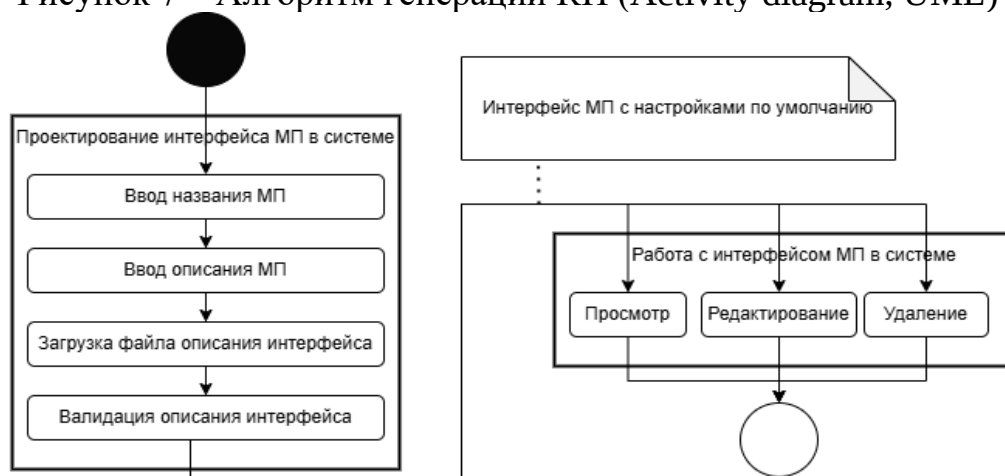
Рисунок 8 – Процесс генерации интерфейсов МП с применением КП (Activity diagram, UML)
