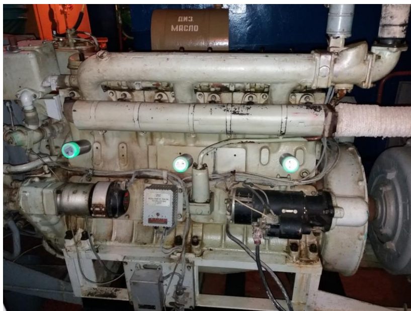
Рисунок 4.4 – Установка датчиков VS-3D на дизель ДГМА-48М1
