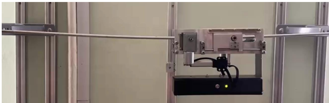
Рисунок 10 – Испытательный стенд робота, перемещающегося по направляющей за счет управления линейным приводом и периодического заклинивания опорных втулок.
