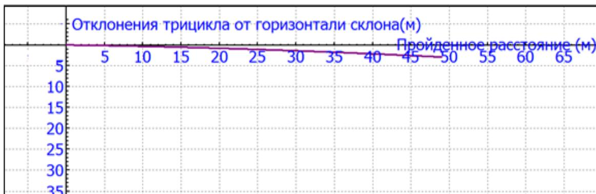
Рисунок 3.6 – График отклонения трицикла без учета стабилизации остова от горизонтали склона крутизной 0.104 рад. ( $6^\circ$ )
