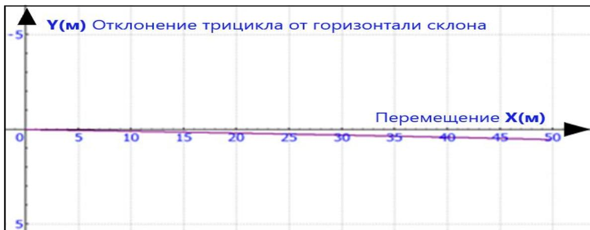
Рисунок 3.4 - График отклонения трицикла с вертикальным положением остова от горизонтали склона крутизной 0.209 рад. ( $12^\circ$ )
