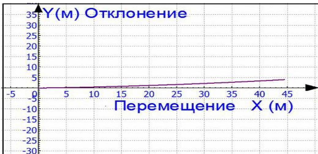
Рисунок 3.19- График траектории движения трицикла со стабилизацией остова на склоне  $0.779$  рад., ( $45^\circ$ ) без опрокидывания
