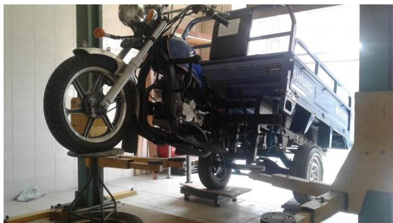
Рисунок 4.3-Определение вертикальной координаты центра масс трицикла.
