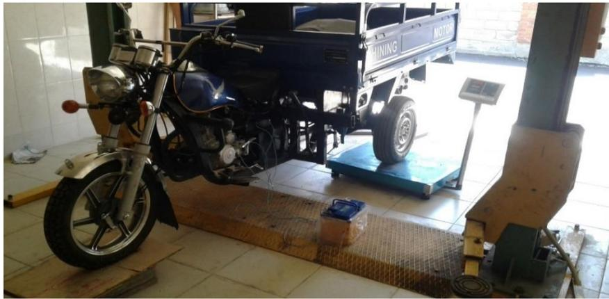
Рисунок 4.2- Определение реакций от опорной поверхности на шины трицикла
