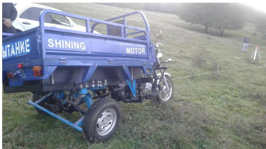
Рисунок 4.6 – Заезд трицикла вдоль горизонталей склона
