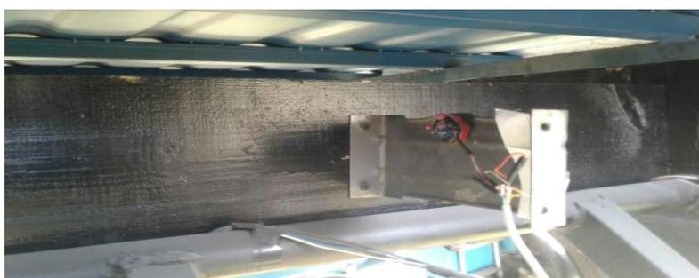
Рисунок 4.11 - Датчик ускорения, установленный на трицикл
