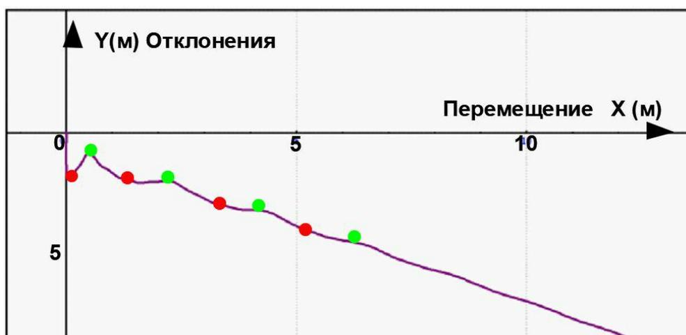
Рисунок 3.14- График неустойчивого движение трицикла на склоне крутизной 0.437 рад., ( $25^\circ$ ) с моментами отрыва колеса от опорной поверхности.
