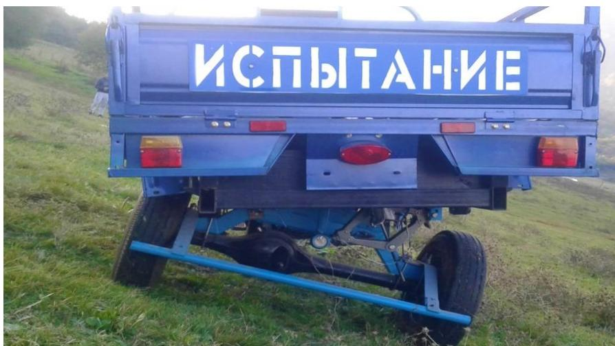
Рисунок 4.4 - Сохранение вертикального положения остова трицикла на склоне
