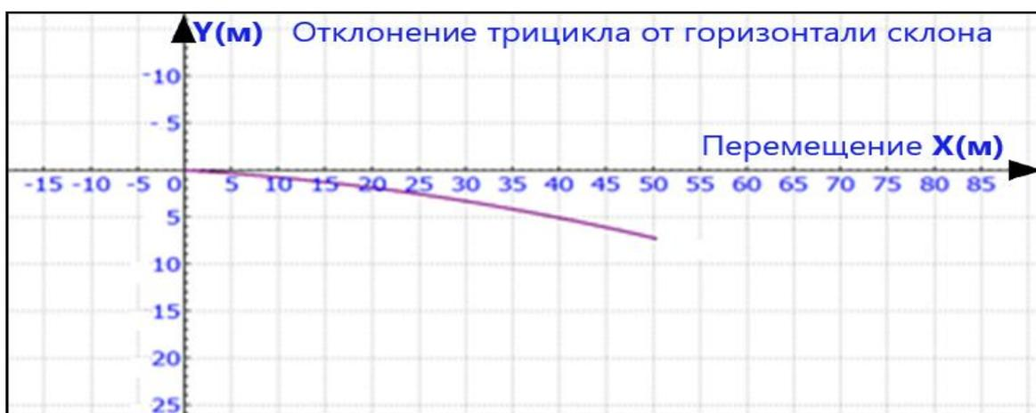
Рисунок 3.2 - График отклонения трицикла без учета стабилизации остова от горизонтали склона крутизной 0.209 рад. ( $12^\circ$ )
