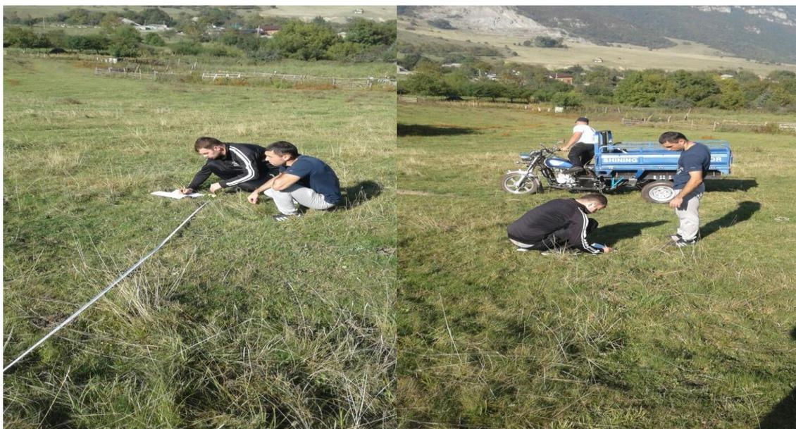
Рисунок 4.9 - Замер отклонений трицикла от заданной горизонтали склона
