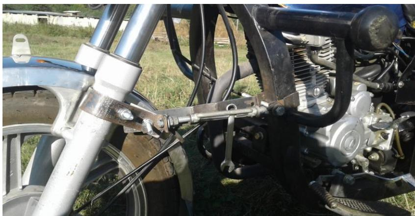
Рисунок 4.7 - Трицикл с жестко фиксированным положением руля
