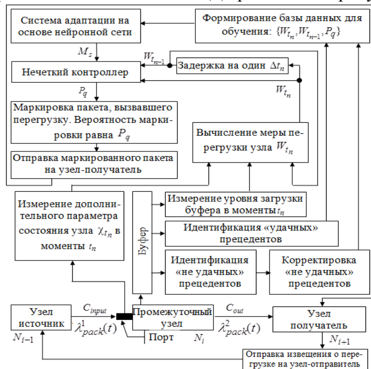
Рисунок 1 – Схема реализации методики для повышения эффективности управления трафиком информационных пакетов в СПД
